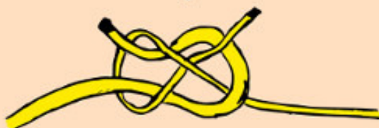
Škotový uzel - váže se na šátku a provazu nebo na dvou různě silných provazech.
